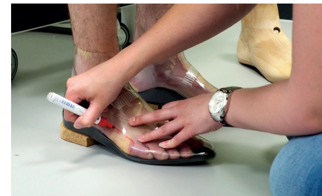
Op basis van de 3D-scan wordt een houten leest gemaakt met daarover een passchoen van folie. Met deze folieschoen kunnen we de pasvorm voor de orthopedische schoenen optimaliseren.
